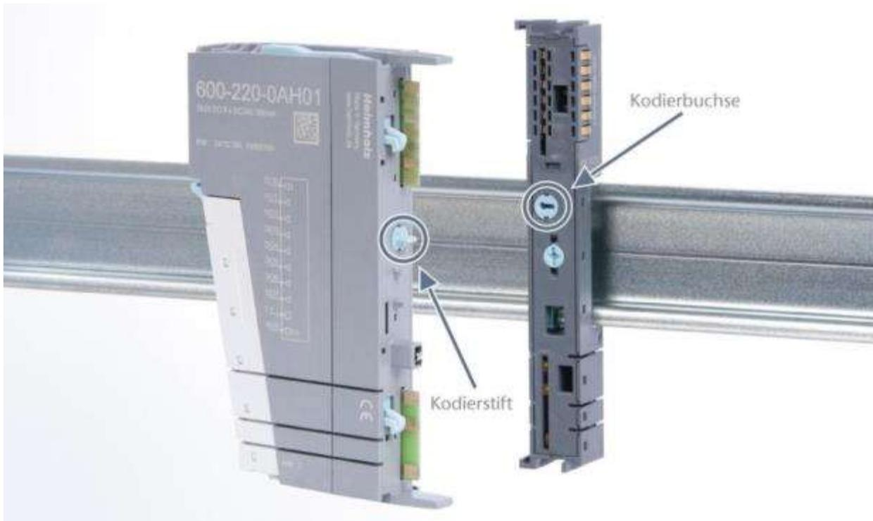
Kodierstift und Kodierbuchse können jeweils acht verschiedene Positionen einnehmen. Jede der acht Positionen ist beim System TB20 werksseitig einer bestimmten Modulart (Digital In, Digital Out, Analog In, Analog Out, Power usw.) zugeordnet. Nur wenn die Position von Kodierstift und Kodierbuchse gleich sind, lässt sich das Elektronikmodul auf das Basismodul stecken. Bei unterschiedlichen Stellungen blockiert das Elektronikmodul mechanisch.
