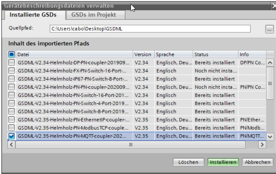
Der PN/MQTT Coupler ist im Hardwarekatalog unter „Weitere Feldgeräte / PROFINET IO / Gateway / Helmholz GmbH & Co. KG“ zu finden.
