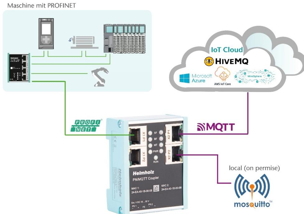
Die Einbindung in das SPS Engineering-Tool wird durch eine GSDML-Datei ermöglicht, eine extra Konfigurationssoftware ist nicht nötig. Die Konfiguration der auszutauschenden EA-Daten wird im Siemens Engineering-Tool durchgeführt. Alle Einstellungen zur MQTT-Verbindung können auf der Webseite des Gerätes durchgeführt werden.
