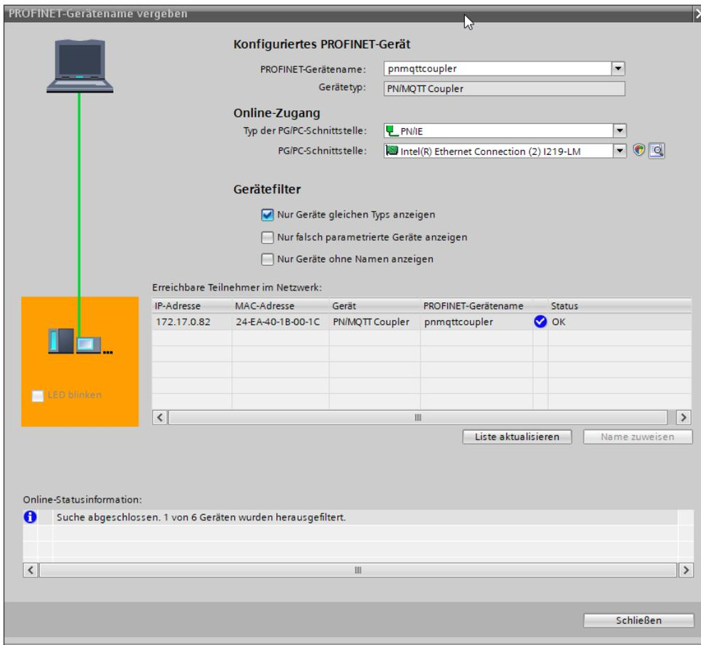
Hat der PN/MQTT Coupler den richtigen PROFINET-Namen erhalten, dann wird er durch die SPS erkannt und konfiguriert. Ist die Konfiguration korrekt verlaufen, sollte die PROFINET „BF“-LED aus sein.
