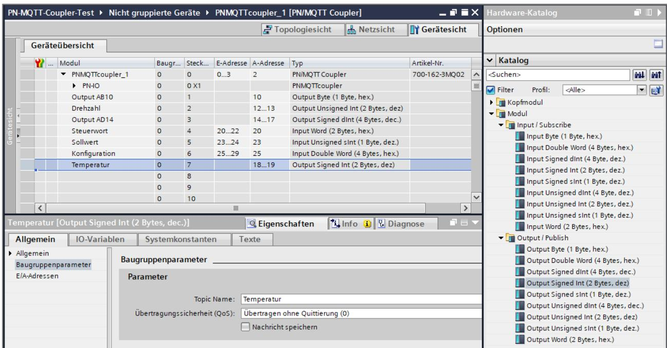
Bei jedem Modul muss in den Baugruppenparameter der **Name des Topics eindeutig** festgelegt werden. Der Name kann z.B. passend zum symbolischen Namen des SPS-Wertes gewählt werden. Es stehen bis zu 40 Zeichen zur Verfügung.
