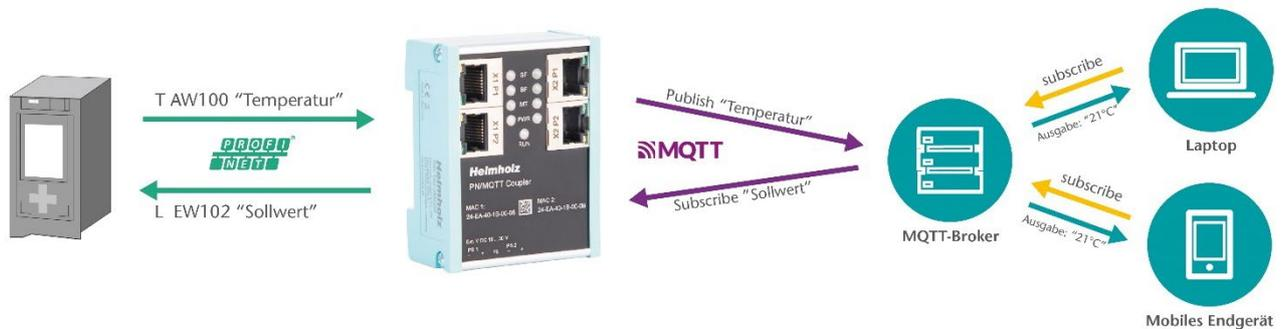
Ein Modul repräsentiert immer genau einen Wert, der über ein MQTT-Topic Namen mit dem Broker ausgetauscht wird. Ein Wert wird über MQTT üblicherweise in einer lesbaren Form gesendet (direkter Text oder JSON formatiert). Aus diesem Grund gibt es für jede Wertgröße (1, 2, 4 Bytes) unterschiedliche Darstellungsformen: hexadezimal, dezimal ohne Vorzeichen, dezimal mit Vorzeichen.
