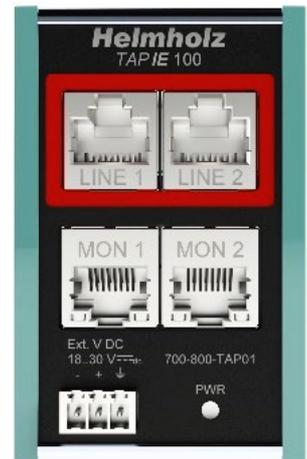
Die Buchsen „LINE 1“ und „LINE 2“ sind physikalisch miteinander verbunden. Die Ethernet-Übertragung wird nicht beeinflusst. Aus diesem Grund haben die beiden RJ45 Buchsen auch keine Status-Leds! Bitte beachten Sie, dass die Gesamtlänge der Kabelverbindungen zwischen dem Teilnehmer an LINE 1 und dem Teilnehmer an LINE2 nicht größer als die bei Ethernet maximal erlaubte Kabellänge sein darf (üblicherweise <100m).
